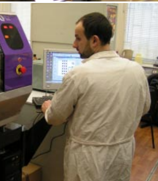
Прибор запоминает положение колоний и переносит их в лунки планшета для дальнейшего изучения. Другой прибор добавляет к бактериям субстрат, чтобы узнать по появлению окраски, способны ли они его переработать
